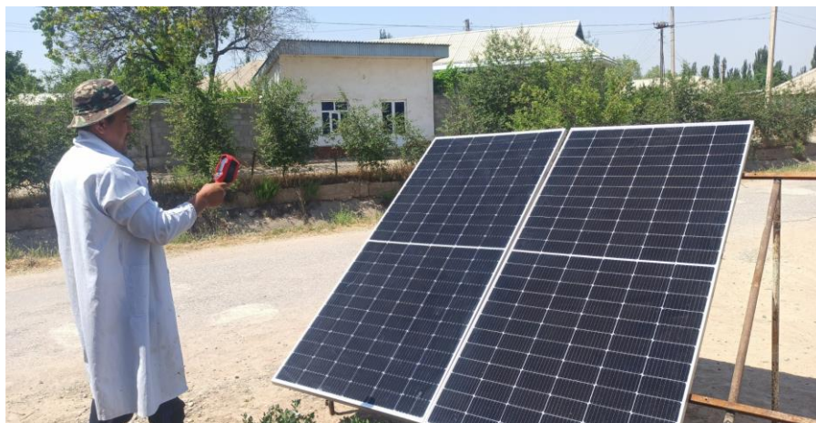
Rasm 2. Quruqlikda o‘rnatilgan panellarda haroratni o‘lchash jarayoni.
